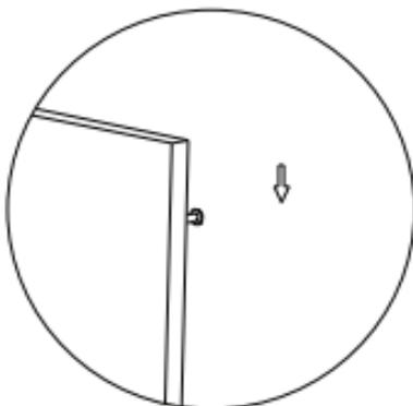
7.3 Installare la sonda di misurazione sulla parete con il nastro doppio adesivo e non lasciare spazio tra il pavimento e la sonda di misurazione.
