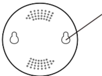
2) Montare le due viti nella confezione e lasciare un bordo di 5 - 8 mm al muro. Adesso è possibile fissare il dispositivo.
